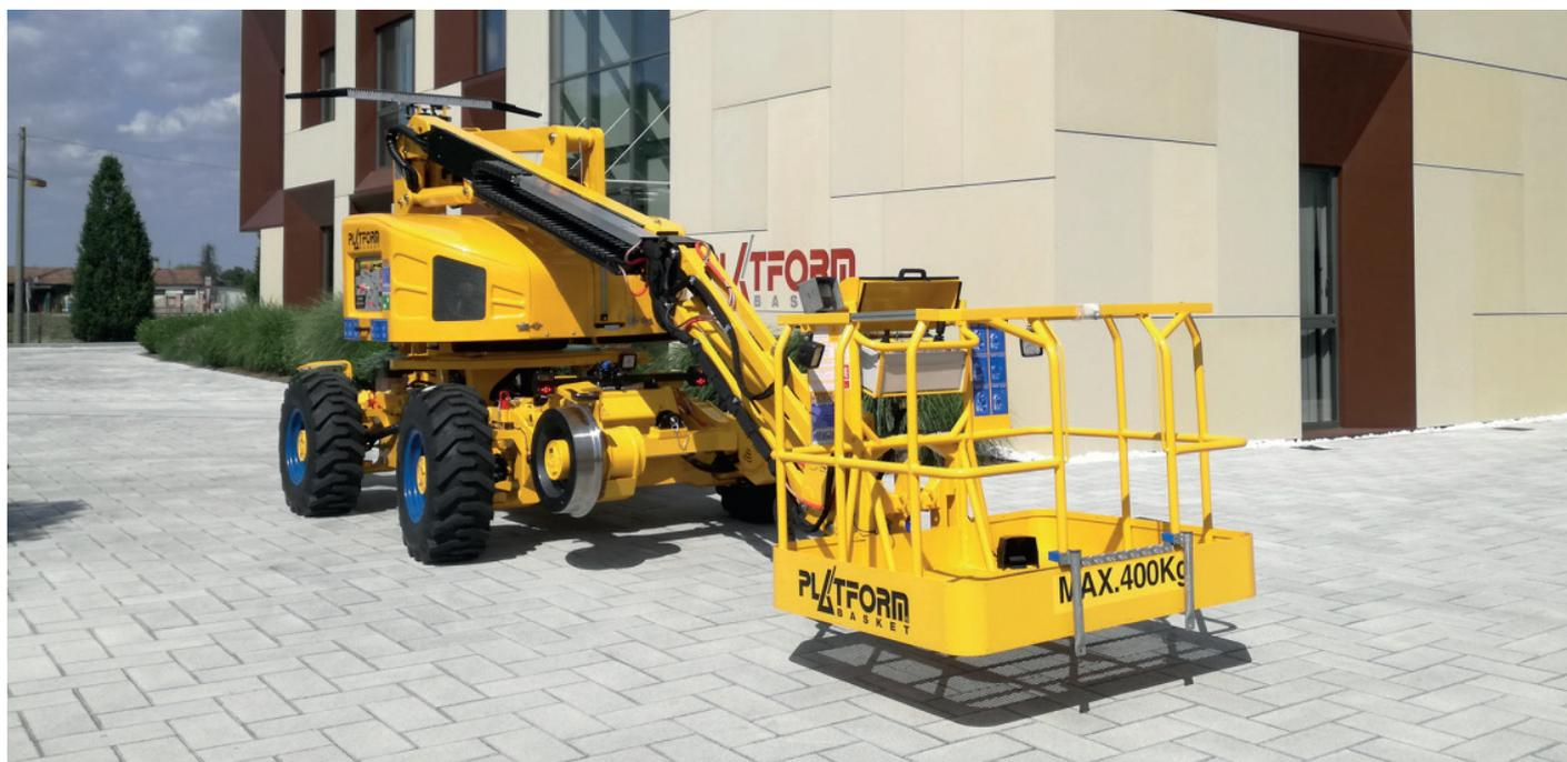
La RR 14 EVO è una piattaforma di lavoro bidirezionale versatile, specialmente progettata per affrontare le sfide della costruzione e della manutenzione sui binari.
